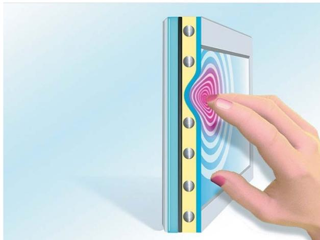
Abbildung 3: Schaubild eines resistiven Touchscreens aus [Com]
